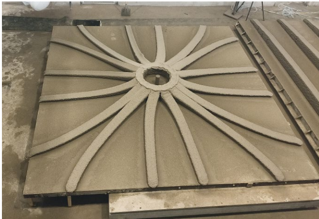
Bild 11 Im Add-on 3-D Printing hergestelltes, 16 m 2 großes Deckenelement für eine punktgestützte Decke 16 m 2 ceiling element for a point supported ceiling using Add-on 3-D Printing
