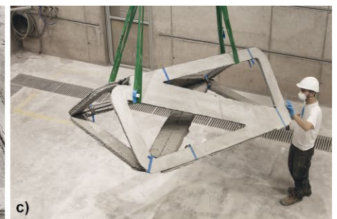
Bild 13 a) Planares Drucken der abgewickelten Bauteile, b) subtraktive Nachbearbeitung der Kanten zum Fügen durch Trockenstoßverbindungen, c) räumliches Modul aus drei planar gedruckten Segmenten a) Planar printing of the unwound components, b) subtractive finishing of the edges for joining by dry joints, c) spatial module of three planar printed segments
