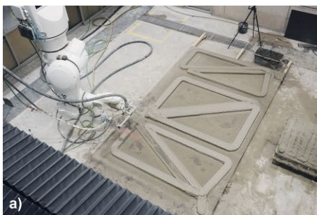
Bild 13 a) Planares Drucken der abgewickelten Bauteile, b) subtraktive Nachbearbeitung der Kanten zum Fügen durch Trockenstoßverbindungen, c) räumliches Modul aus drei planar gedruckten Segmenten a) Planar printing of the unwound components, b) subtractive finishing of the edges for joining by dry joints, c) spatial module of three planar printed segments
