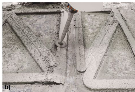
Bild 13 a) Planares Drucken der abgewickelten Bauteile, b) subtraktive Nachbearbeitung der Kanten zum Fügen durch Trockenstoßverbindungen, c) räumliches Modul aus drei planar gedruckten Segmenten a) Planar printing of the unwound components, b) subtractive finishing of the edges for joining by dry joints, c) spatial module of three planar printed segments
