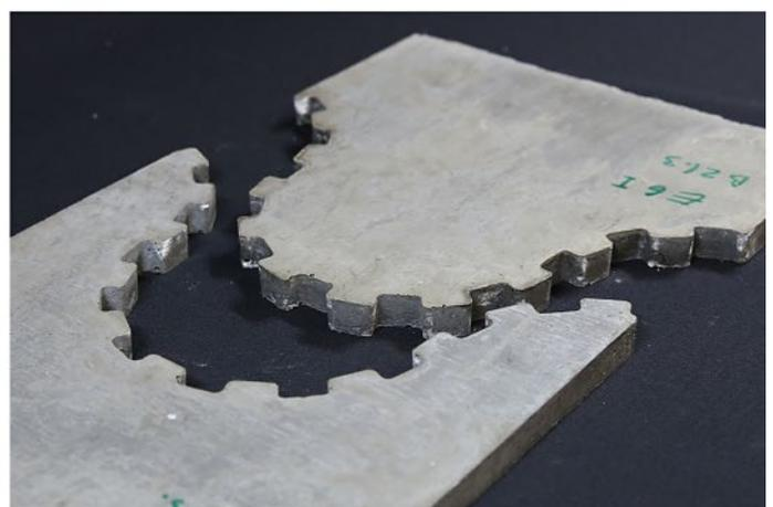
**Bild 13.** Neuartige mechanische Verbindungen für Bauteile aus UHPC: Parametrisch gesteuerte Entwicklung im 3D-Programm und hochpräzise Herstellung mittels CNC-gefräster Wachsschalung, ITE und iBMB der TU Braunschweig, 2014
