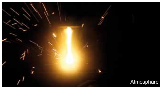
Abbildung 1: Metaldampffackel und Spritzerbildung beim Laserstrahlschweißen mit Festkörperlaser bei verschiedenen Drücken
