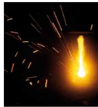
Abbildung 1: Metaldampffackel und Spritzerbildung beim Laserstrahlschweißen mit Festkörperlaser bei verschiedenen Drücken
