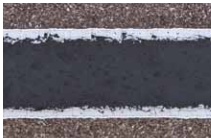
Querschliff durch eine Klebverbindung zweier beschichteter Stähle. Beschichtungen, Diffusionszone und Grundwerkstoff sind deutlich voneinander zu unterscheiden.
