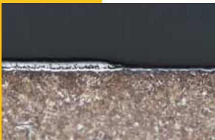
Querschliff im Übergang zur Versagenszone bei einem beschichteten hochfesten Stahl. Im rechten Teil des Bildes ist deutlich die fehlende Beschichtung zu erkennen.
