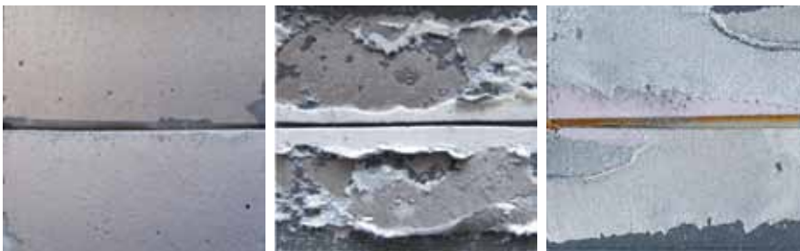
Bruchbilder von beschichtetem 22MnB5 – es ist deutlich zu erkennen, dass in Abhängigkeit der Klebstoffe unterschiedliche Anteile Schichtversagen auftreten.
