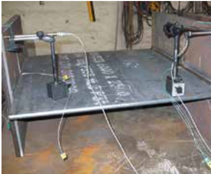
Abbildung 3: Teildemonstrator mit Thermoelementen und Wegaufnehmern
