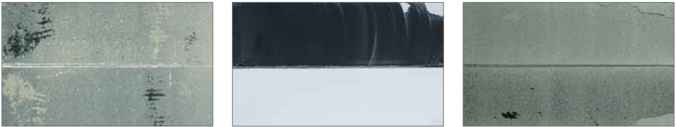
Abbildung 3: Bruchflächen der T-Peel Proben (links: KTL, Mitte: weiß, rechts: silber)
