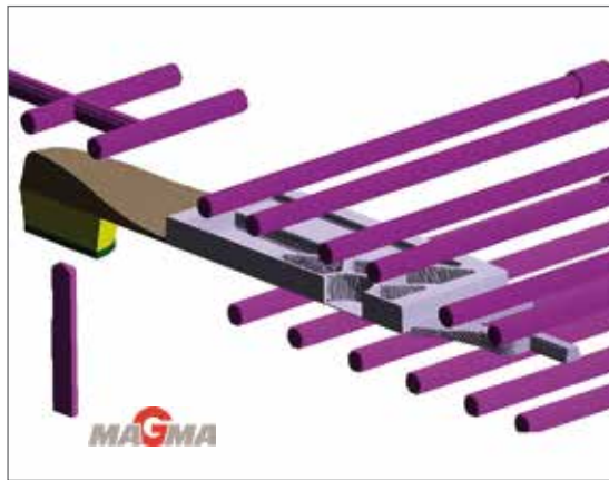
Abbildung 3: Konventionelle Temperierung des vorhandenen Werkzeuges, hergestellt durch Langlochbohrungen
