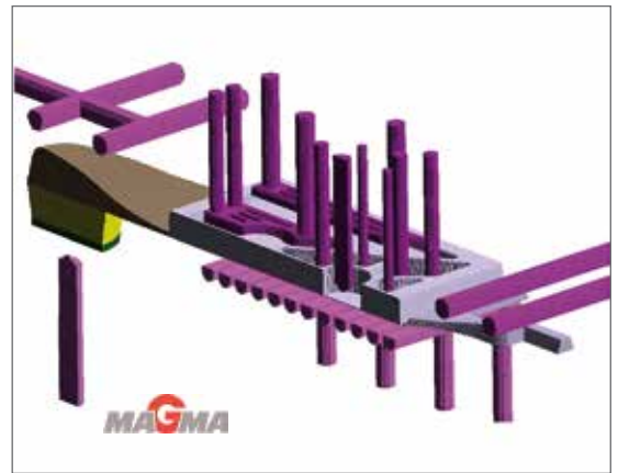
Abbildung 4: Unter Einsatz von Segmentierungen und Stichkühlungen modifizierte Temperiergeometrie
