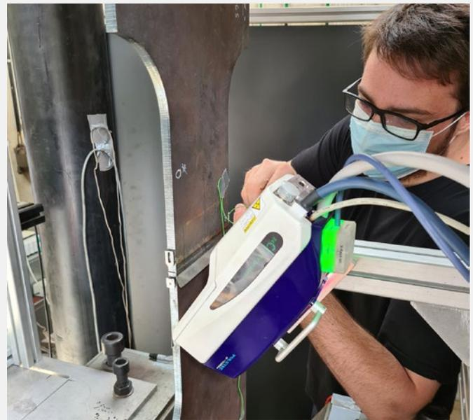
Bild 2: Mobile Messung mit dem portablen Kleinstdiffraktometer
