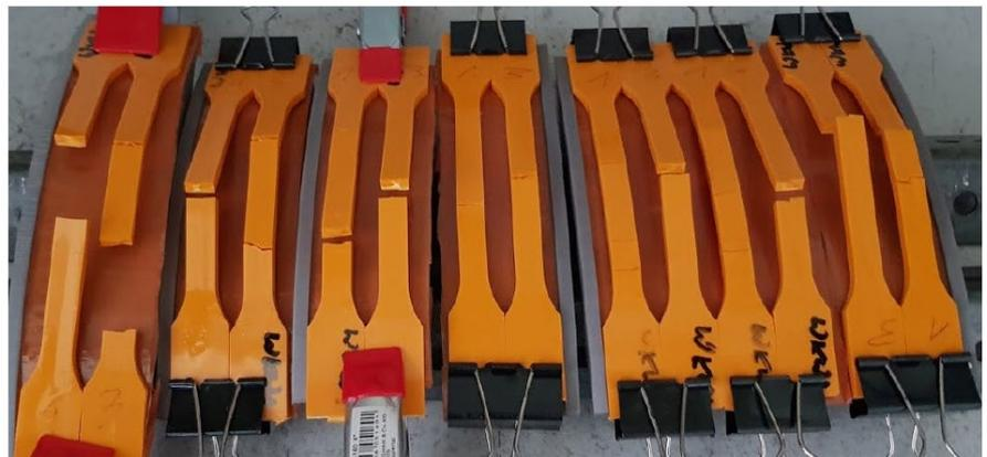
Bild 3: Biegeschablonen, die mit einem 3D-Drucker aus PLA hergestellt wurden zur Ermittlung des ESCR von Klebkomponenten
