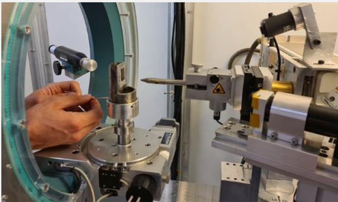
Bild 1: Positionierung einer Probe im Röntgendiffraktometer
