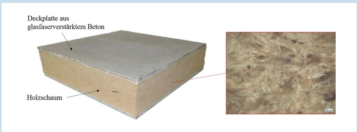
Bild 3: Sandwichelement (300x300x74 mm<sup>3</sup>) mit 2K-PUR-geklebten Deckplatten (5 mm dicker Textilbeton) für die Dämmung der Außenwand. Rechts: vergrößerte Darstellung des Holzschauams mit seinem faserartigen Aufbau
