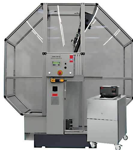
Abbildung 1: Modernes Kerbschlagbiegewerk mit automatischer Pendelanhebung und externer Probertemperaturung (rechts unten), wie es seit Ende 2018 am ifs zur Verfügung steht | Fotomontage: Das Umwälzthermostat ist von der Peter Huber Kältemaschinenbau AG und das Kerbschlagwerk von der Walter + Bai AG (Bilder sind ebenso von den Unternehmen)
