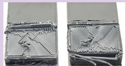
Abbildung 1: Vergleich der Klebbarkeit von Spritzguss- und MEX-Bauteilen über Zugscherversuche (links), typisches Bruchbild mit Delaminierungsversagen der Bauteile (rechts)
